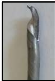
Figura 2. Superficie de fractura del alambre B – delaminada anormal.
