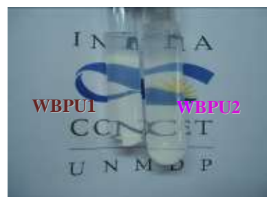
Figura 3. Aspecto de las dispersiones de poliuretanos de base acuosa.
