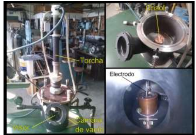
Figura 1: Horno de arco utilizado en este trabajo. Pueden verse indicados algunos de los componentes principales
