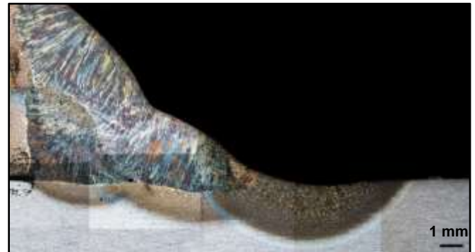
Figura 2. Micrografía probeta TIG. Nital 3%.
