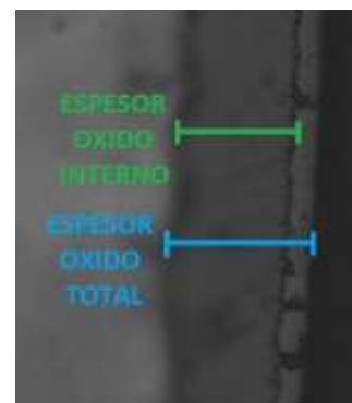
Figura 3. Aspecto de las capas presentes en la cascarilla del producto
