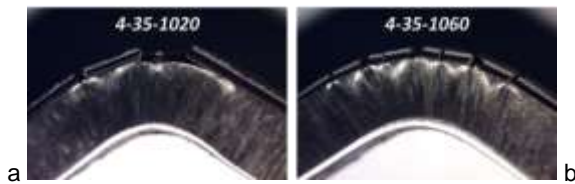
Figura 6. Detalle de las probetas refundidas a 1020 (a) y 1060°C (b) luego de realizado el plegado.
