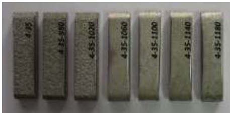
Figura 2. Aspecto superficial de muestras recubiertas en condición AS y refundidas a distintas temperaturas.
