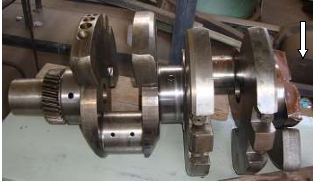
Figura 2. Indicación de la zona de fractura
