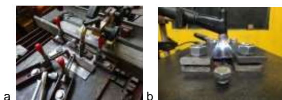
Figura 1. Montaje experimental: a) GMAW; b) PAW.
